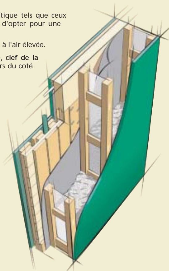
U*psi : Exemple de construction pour façade accrochée
